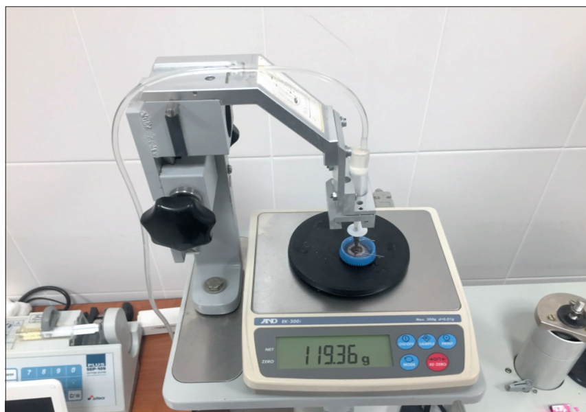
Рис. 1. Биомеханическая испытательная установка в момент прокалывания образца
